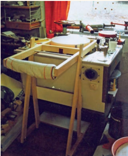
Abb. 4 Mit dieser hölzernen Hilfsvorrichtung konnte ich den schweren Spiegel mühelos (auf 4 Lenkrollen) von der Poliermaschine abheben und in eine geeignete Prüfposition fahren.
