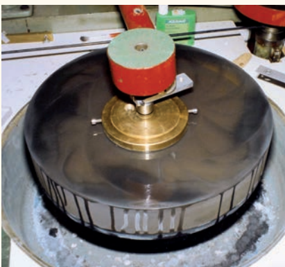
Abb. 5 Die Maschine wird für zonenweises Polieren vorbereitet.
